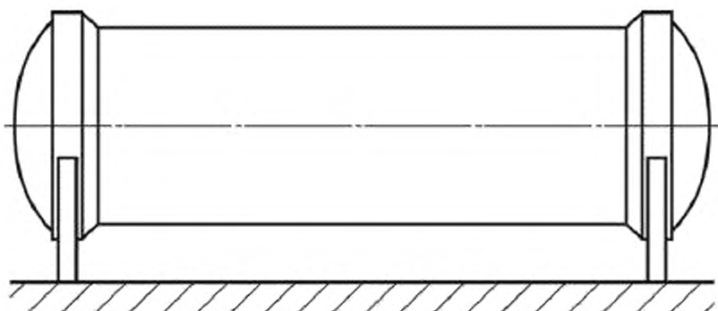
Рисунок 9.4 — Хранение емкости на двух опорах
