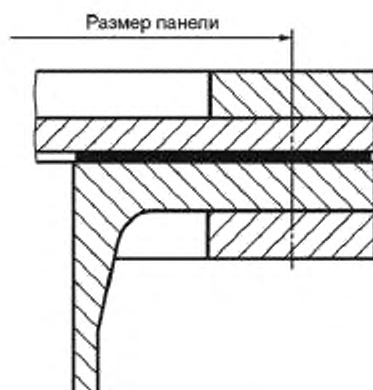
Рисунок Е.2 — Крепления в соответствии с типом 1: фланцевая заглушка с плоской опорной поверхностью и подкладными кольцами
