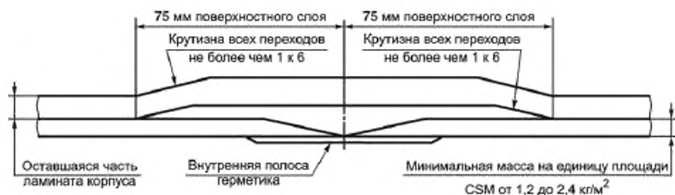
Рисунок И.4 — Основные типы сварных соединений для напорных емкостей без термопластичной футеровки: форма поверхностного слоя
